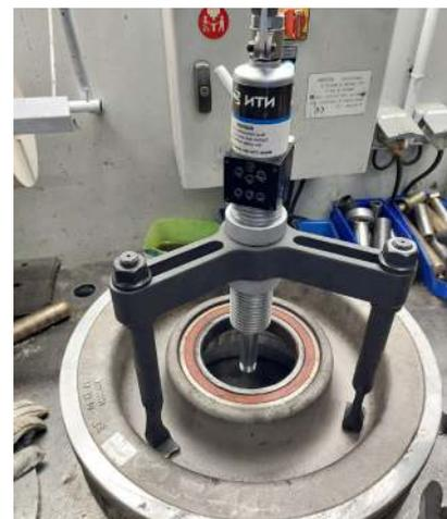
Installation du Push/Puller sur la seconde face, avant mise en place de l'extracteur
