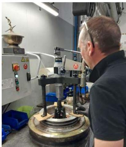
Pour ne pas abimer le galet, il est recommandé de placer des cales de protection
