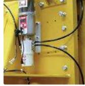
Pression en service de 25 bars permettant un montage déporté jusqu'à 5 m pour chaque sortie
