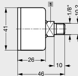
1 Montage avec une clé plate de 14 mm
